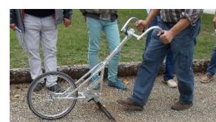
Houe « communale » : binette améliorée surfaces sableuses et gravillonnées - Tillou -
